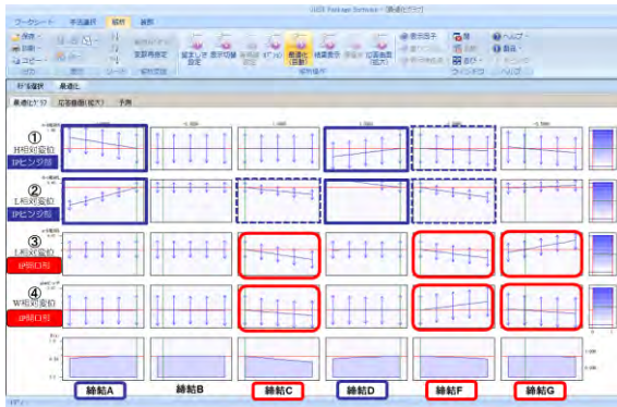
[図. 3] 応答曲面法解析による要因効果図
