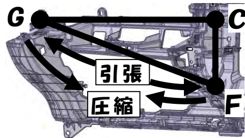
[図. 4] インパネの変形モード
