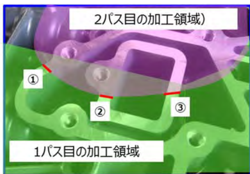
Fig.4 段差発生部位と加工領域
